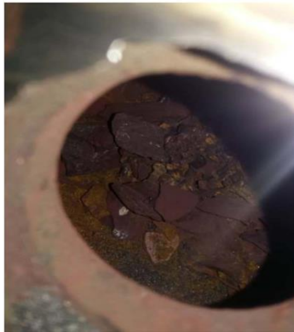
شکل (۷) هدر پایین اوپراتور اولیه قبل از تعویض لوله ها که پر از اکسید های لایه ای است.
