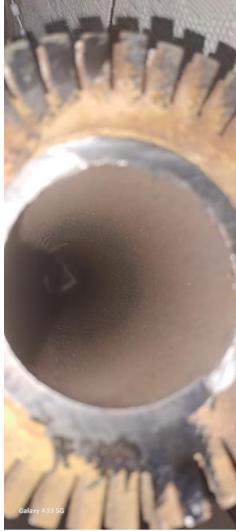
شکل (۶) نمونه لوله اوپراتور ثانویه (تعویض نشده) بعد از اسیدشویی-رسوبات کاملاً از بین رفته است
