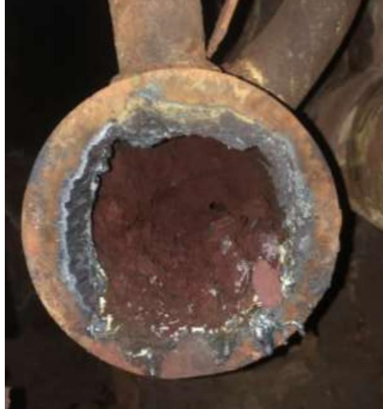
شکل (۸) هدر پایین اوپراتور اولیه قبل از درین که پر از رسوبات و محصولات خوردگی است.
