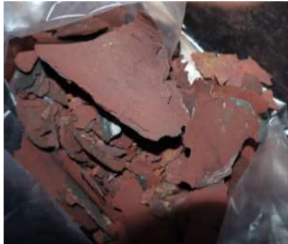
شکل (۹) نمونه لایه های خوردگی جدا شده از لوله ها قبل از تعویض لوله ها
