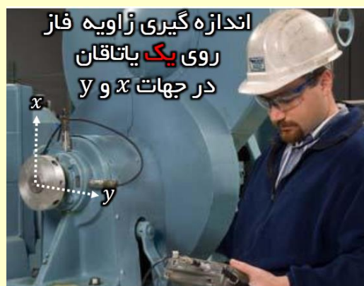
شکل ۳ اندازه‌گیری اختلاف فاز راستای y و x روی یک بیرینگ
