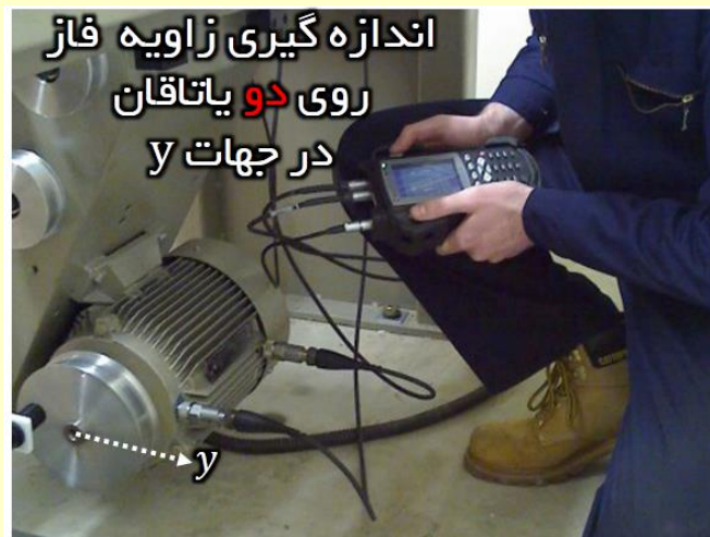
شکل ۲ اندازه‌گیری زاویه فاز در روی دو یاتاقان
